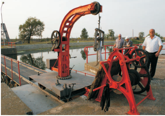
Kołowrót i żurawik na moście jazowym stopnia wodnego Klek, 1914
